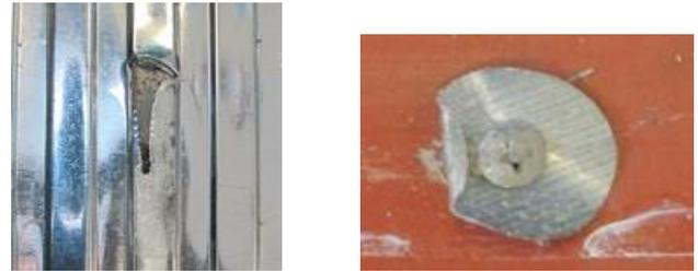
写真4 試験体1のせん断垂直時の破壊状況
