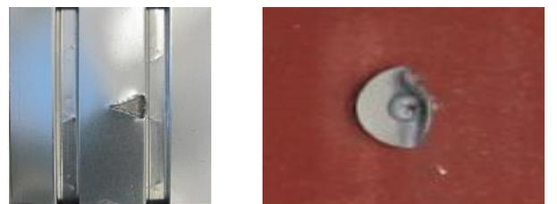
写真8 試験体6のせん断平行時の破壊状況
